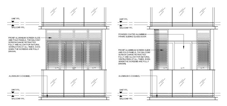
TYPICAL RETRACTABLE BALCONY SCREEN ELEVATION (\*FULLY DRAWN)
